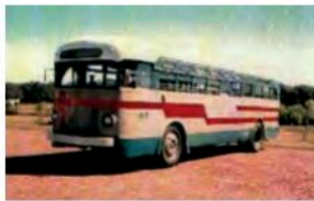
Carrocería sobre chasis Leyland Tiger, copia del GMC TDH 3610, con caja de cambios a palanca, similar al Olympic EL40. Fabricada en Línea "D".
