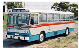
1975 - Banda Oriental II sobre chasis Leyland Royal Tiger Worldmaster con caja neumocíclica Gb106.
