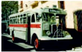
1937 - Aclo Regal, carrozado en Uruguay con cabina a la derecha y estructura de madera.
